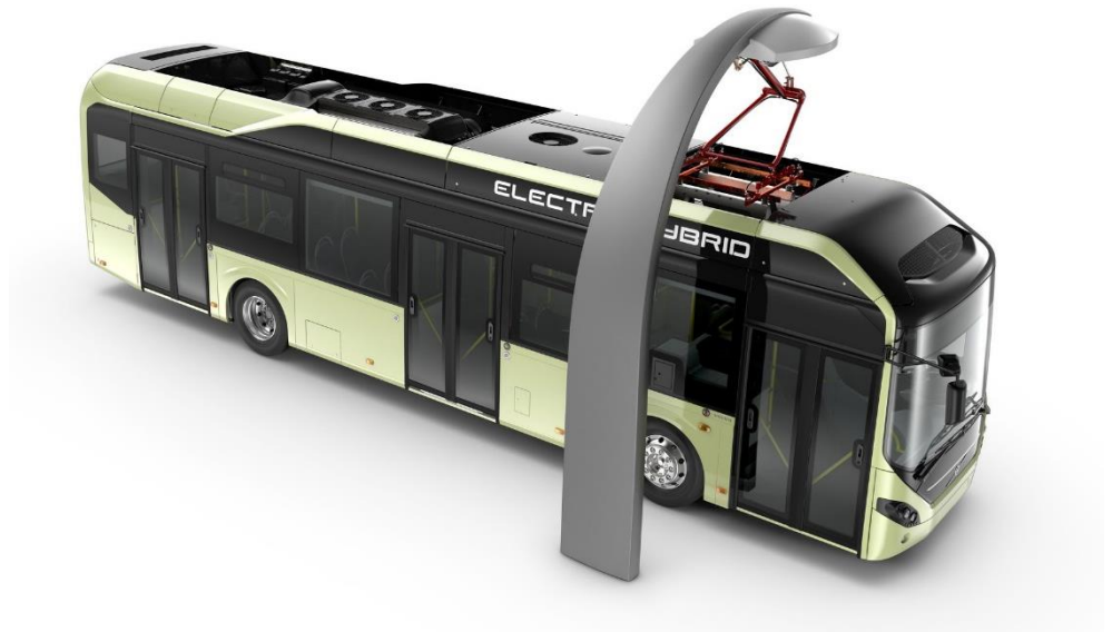
Figur 8 Skitse af en Volvo plugin hybrid bus, der oplades ved hjælp af en pantograf-løsning. Kilde: Insideevs.com
